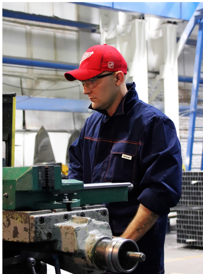
Роман вырезает образцы профиля – заготовки, вытяжки из металлических столбов – для анализа их химических и физических свойств
