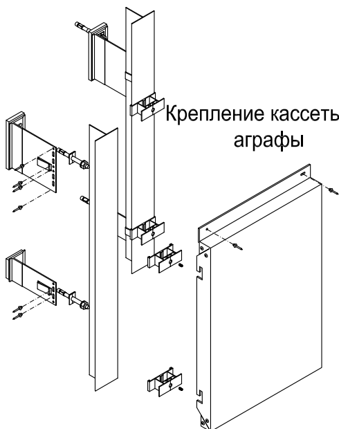
Крепление кассет на алюминиевые кассетные профили
